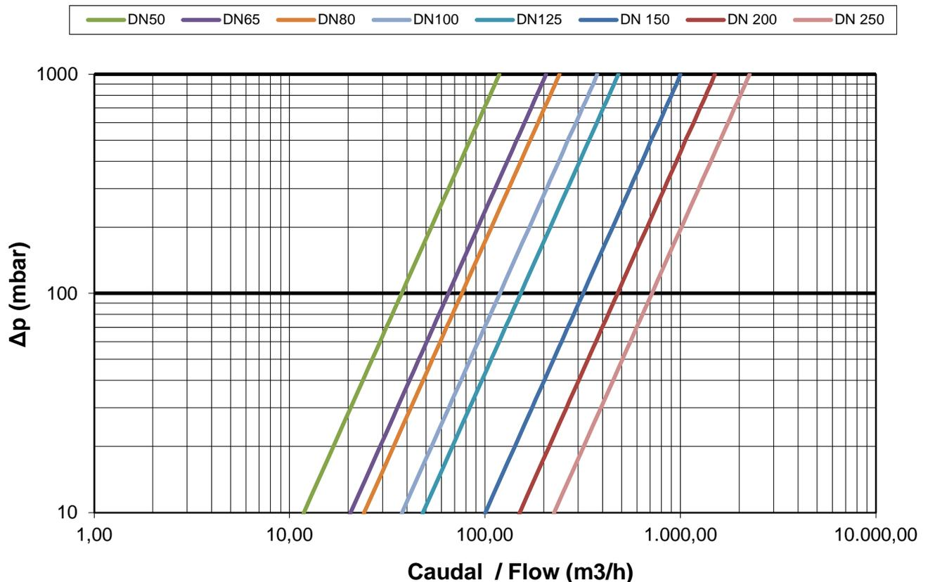
\* Contador con clase de pérdida de presión  $\Delta P10$ . ( $\Delta P16$  en DN50 y DN125). Por lo que la máxima pérdida de carga será de 100 mbar (160 mbar en DN50 y DN125). Tenerlo en cuenta a la hora de consultar el caudal en la gráfica. / Water meter pressure loss class  $\Delta P10$ . ( $\Delta P16$  in DN50 and DN125). So maximum head loss will be 100 mbar (160 mbar in DN50 and DN125). Keep in mind when you see the flow in the graph.
